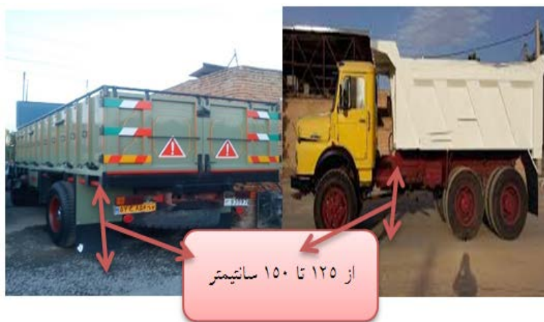
شکل ۱۱- وضعیت ارتفاع زیر سپر انواع وسیله نقلیه تا سطح زمین
