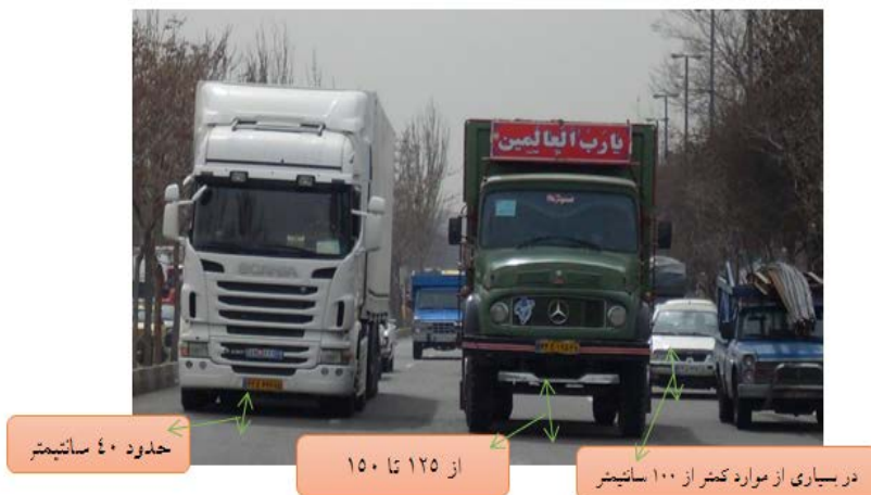
شکل ۱۱- وضعیت ارتفاع زیر سپر انواع وسیله نقلیه تا سطح زمین
